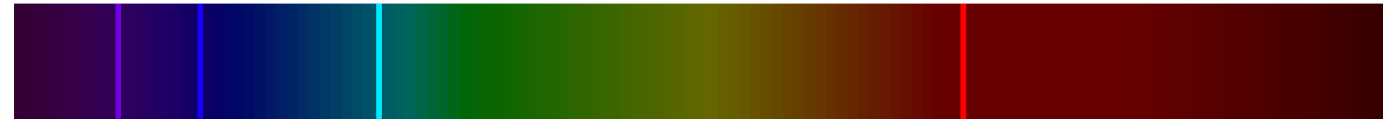
Espectro discreto de emisión del hidrógeno (H).
