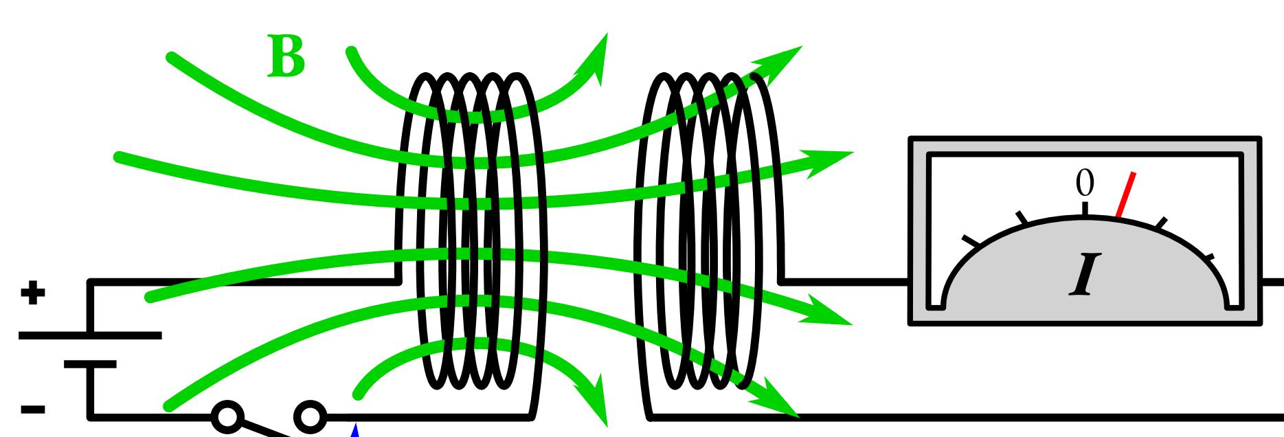
Al abrir y cerrar el interruptor del primer circuito se genera de forma instantánea una corriente inducida en el segundo circuito, la cual aparece únicamente en el instante en el que se abre o se cierra el interruptor; si permanece abierto o cerrado no se detecta corriente inducida. Adaptada de <https://commons.wikimedia.org/wiki/File:Induction-by-a-changing-magnetic-field.svg>.
