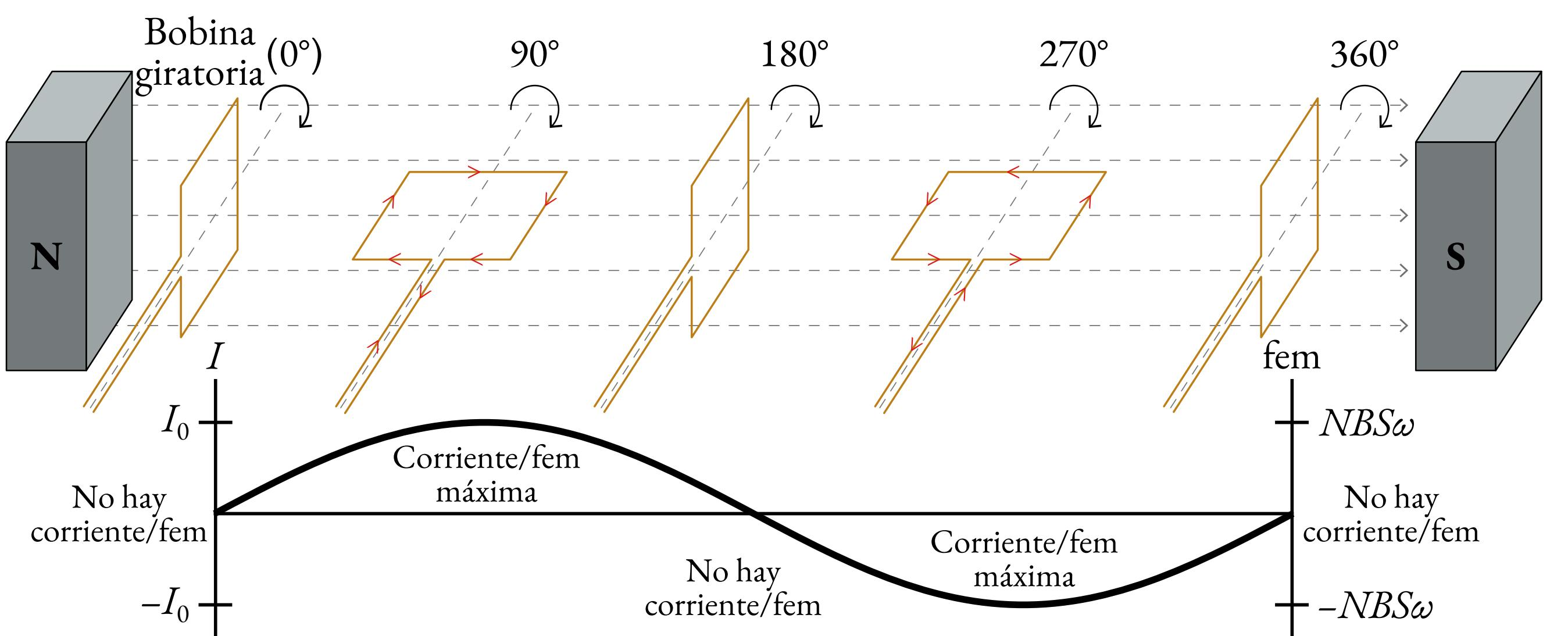
GENERADOR DE CORRIENTE ALTERNA, basado en la variación del ángulo formado entre el campo magnético y la superficie de una bobina, que gira en su seno con velocidad angular constante. Adaptada de <https://www.nagwa.com/en/explainers/357172034271/>.
