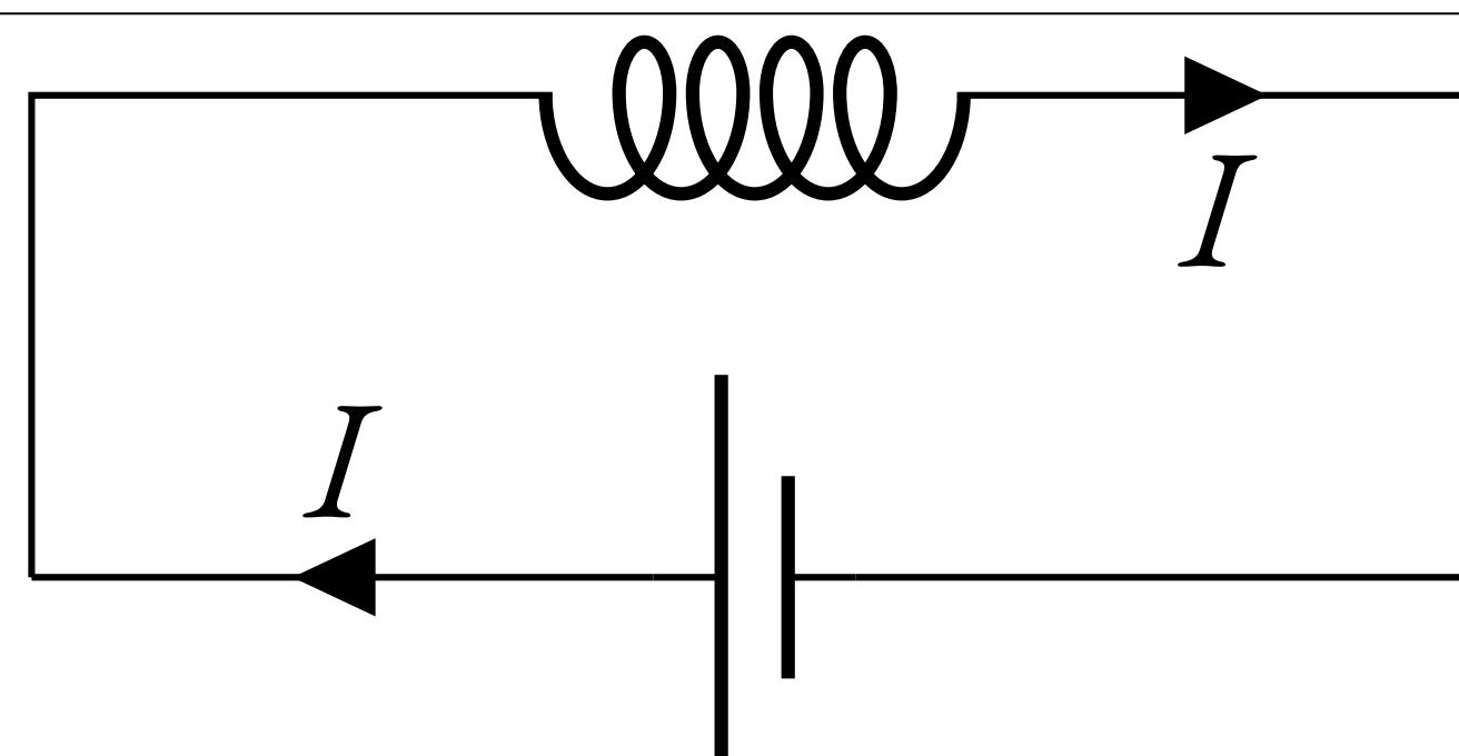
La AUTOINDUCCIÓN consiste en la inducción de una corriente sobre sí misma. Para que se produzca, es necesario que la corriente que recorre un circuito varíe con el tiempo. Consideraremos un solenoide de longitud  $\ell$  y radio  $R$  formado por  $N$  espiras. El solenoide forma parte de un circuito en el que existe un generador de corriente continua y cuya resistencia es  $r$ .
